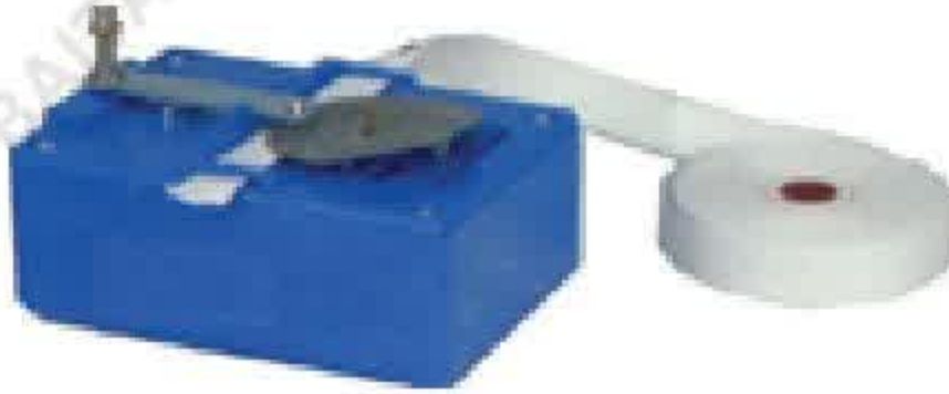
Hình 6.3. Đồng hồ cần rung
