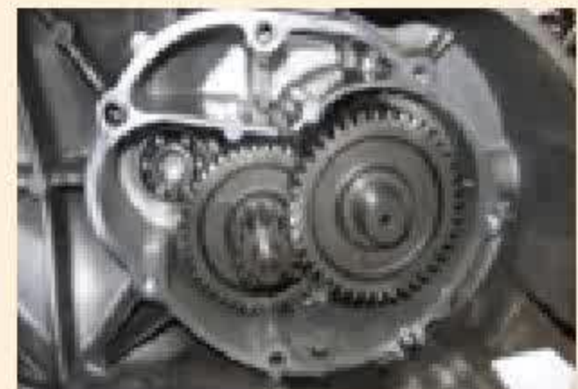
Hình 24.2. Hộp số xe máy
